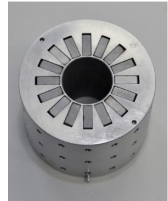
Halbach array in a Linac 4 PMQ
